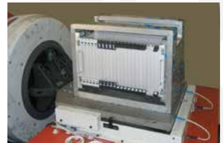
Bild: Schock- und Vibrationstest nach MIL 810G und IEC 61587-1, Anforderungsstufe DL 2 und DL3
