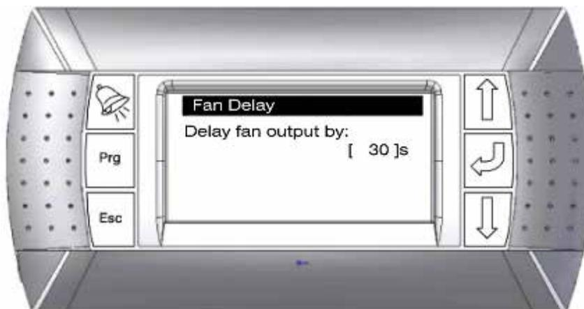
Lorsque le cavalier DL (à l'intérieur de l'unité CMS sous l'indicateur d'alarme) est réglé sur ON, une temporisation matérielle du ventilateur est appliquée.
