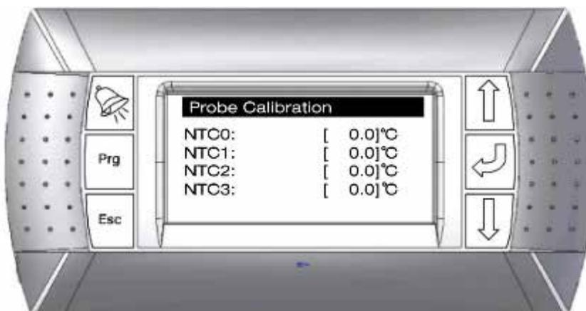
Cet écran permet d'étalonner les sondes de température et d'humidité NTC installées sur le CMS ou d'appliquer des valeurs décalées.
