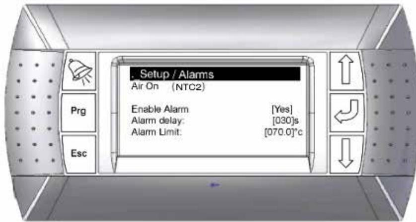
Cet écran permet la configuration d'une alarme pour prévenir d'une éventuelle situation d'incendie. La température de déclenchement peut être sélectionnée entre 70 °C et 100 °C.
