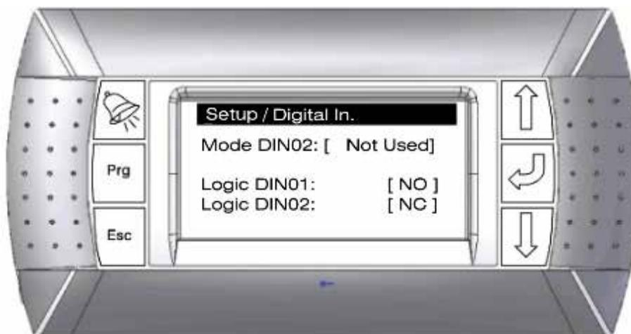
Logic DIN 01 est l'entrée de la carte d'alimentation qui signale au c.pCO que l'alimentation est passée de A à B.
