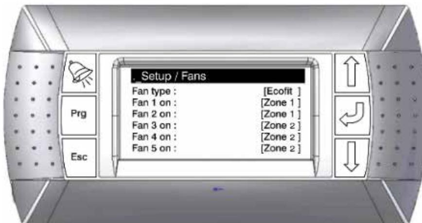
Cet écran permet de régler le type de ventilateur (Ziehl, EBM, Ecofit, etc.). Lorsque la commande de 2 ou 3 zones a été sélectionnée, les différents ventilateurs peuvent être configurés pour des zones différentes. Le câble de commande des ventilateurs devra être changé sur la sortie Y1, Y2 ou Y3 appropriée.
