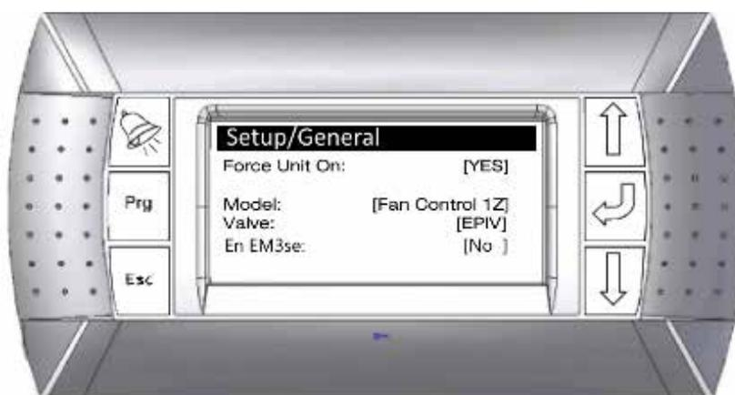
**Le réglage « Force unit on » force l'unité à s'allumer automatiquement lorsque le système démarre.**
