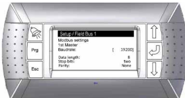
Le seul réglage à modifier sur le bus de terrain est la vitesse de transmission à 19 200 bauds. S'assurer que les sondes en série ont été réglées de sorte que la longueur des données, les bits d'arrêt et la parité correspondent aux réglages affichés à l'écran.
