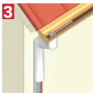
**3** **Déneigement et mise hors gel de chéneaux, gouttières et tuyaux de descente**
