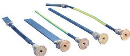
Les ponts de mise à la terre sont des ensembles faits d'un point de mise à la terre de qualité supérieure (borne de connexion) et de divers types de conducteurs. Le processus de connexion exothermique nVent ERICO Cadweld sert à les combiner pour former un ensemble durable et hautement résistant à la corrosion.
