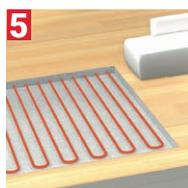
**5** **Chauffage électrique par le sol**
