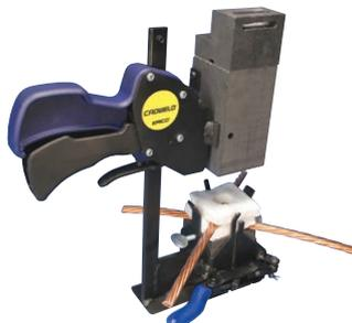
Le procédé de soudure exothermique nVent ERICO Cadweld fond les conducteurs ensemble, réalisant ainsi une liaison moléculaire possédant une capacité de passage du courant égale à celle des conducteurs. Un circuit de terre utilisant ce type de liaison constitue un circuit de faible résistivité sans aucun point faible.
