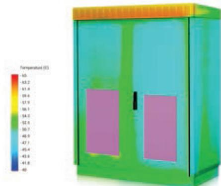
nVent SCHROFF工程团队运用热力模型来创建定制冷却解决方案，确保室外Modular机柜的每个热点都能得到理想冷却，同时平衡冷却系统的整体能耗。
