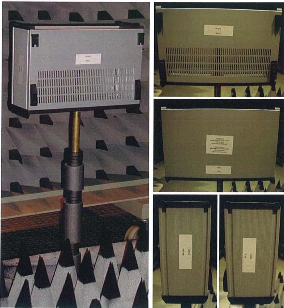
Abbildung 4: Prüfling am festgelegten Messplatz
