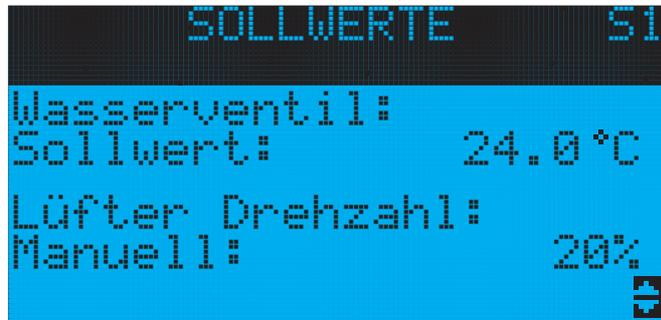
wird der Sollwert für die Regelung des Wasserventil eingestellt. Wenn die Regelung über einen Temperatursensor erfolgt kann die Temperatur in °C (°F) eingegeben werden, bei manueller Regelung kann der Öffnungsgrad des Wasserventils in % eingegeben werden.
