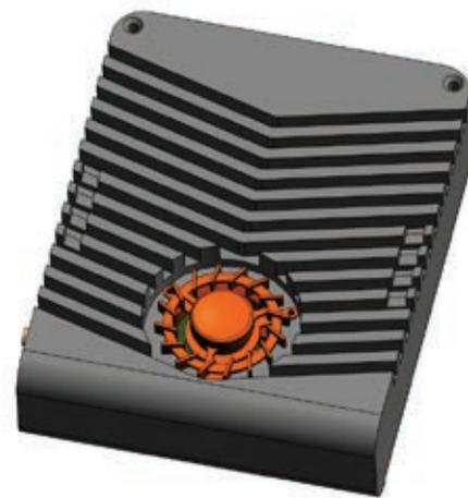
Ein optionaler **Radiallüfter** ist unter dem Deckel angebracht, zieht die Wärme aus dem Gehäuseinneren und führt gleichzeitig die Wärme an den Kühlrippen ab.
