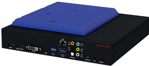
Das Ganze liefert nVent auf Wunsch als Gesamtlösung inklusive COM-Modul, Festplatte etc. in einem Interscale-Gehäuse mit Kühlung und Stromversorgung.
