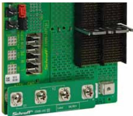
Applikation: Power Backplane (links), CompactPCI Serial Backplane (rechts) und Verbindung mit Power Adapter Board (unten)
