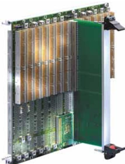
Abbildung zeigt primäre und sekundäre Backplane mit aufgesteckter Bridge und gestecktem Rear Transition Board
