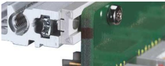
Modulschiene hinten zur Backplanemontage mit Isolierstreifen
